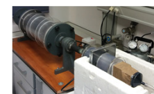
Naprava za ločevanje delcev na različne velikosti (PM 10 and PM 2.5 )
